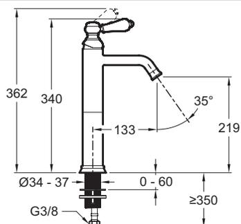
Спецификация продукта : Высокий смеситель для раковины. E24361. Коллекция : LOUISE. МАТЕРИАЛ : N/A. ТИП УСТАНОВКИ : 1 отверстие. TYPE : Однорычажный. DÉBIT (L/MN SOUS 3 BARS) : 5 л/мин. HAUTEUR TOTALE DU ROBINET (MM) : 219 мм.
