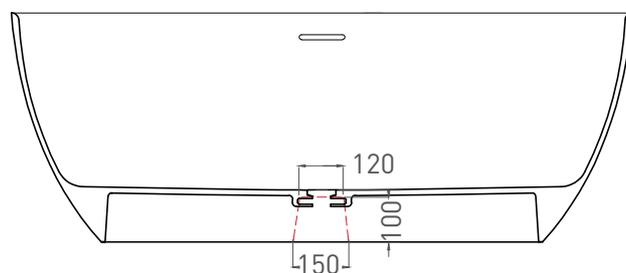
\* Расположение стандартного технологического отверстия на задней стенке. В базовую комплектацию не входит, заказывается отдельно.
