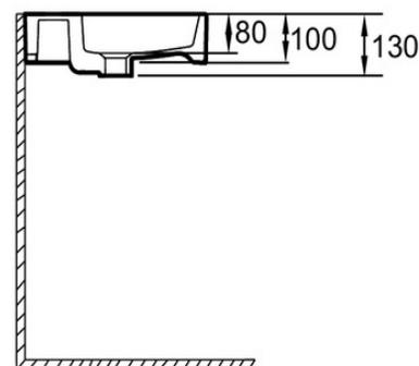
Спецификация продукта: Накладная раковина-чаша 50 x 40 см. EVT112. Коллекция: SULLY. РАЗМЕРЫ (СМ): 50 x 40 см. ВЕС: 10 кг. МАТЕРИАЛ: Огнеупорная керамика. УСТАНОВКА: Накладные. В комплекте: заглушка слива.
