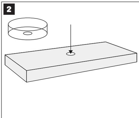
Просверлите в столешнице отверстие с учетом размеров имеющегося у вас сливного набора (не входит в комплект). Важно учесть толщину столешницы для подбора сливного набора.
