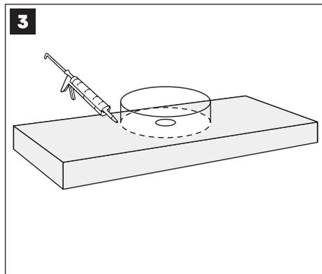
Установите и зафиксируйте раковину на столешнице при помощи санитарного герметика, состав которого подходит для выбранного типа столешницы.
