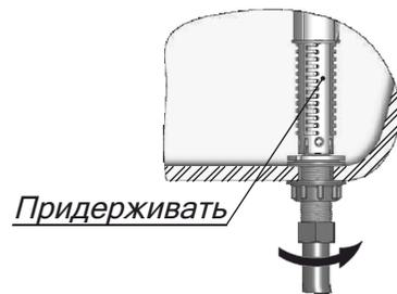
При подсоединении водопроводного шланга к наполнительному клапану, придерживайте клапан от проворота.
