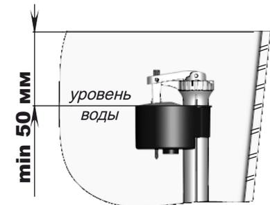
**ПРИМЕЧАНИЕ:** Из-за наличия в воде различных примесей со временем возможно ухудшение работы сливного и наполнительного клапанов, вследствие выпадения на их деталях осадка. В этом случае необходимо извлечь клапаны из бачка, промыть чистой, проточной водой и установить на место.
