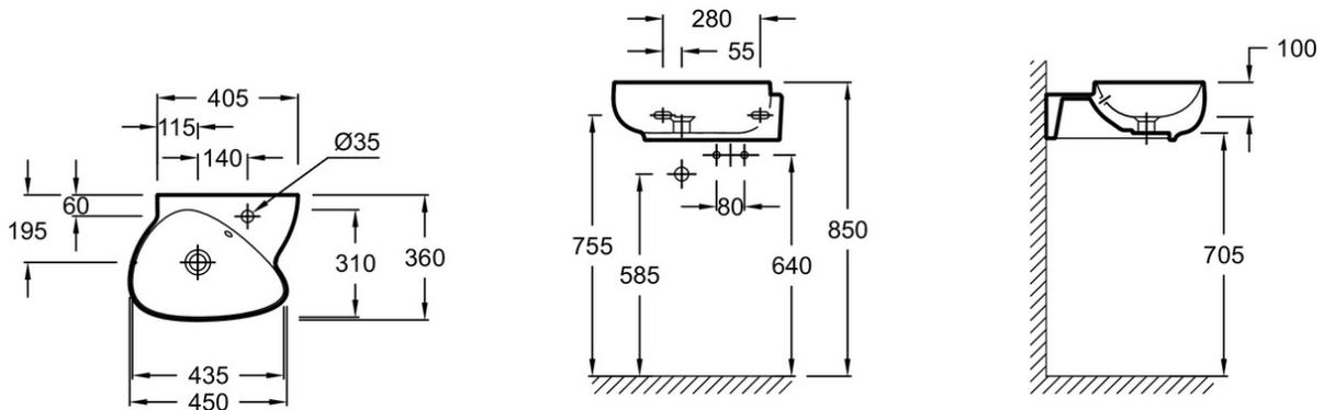
Спецификация продукта: Раукоуойник 45x36 .EGK112. Коллекция : NOUVELLE VAGUE. РАЗМЕРЫ (СМ): 45x36 см. ВЕС: 12 кг. МАТЕРИАЛ: Керамика. УСТАНОВКА: Подвесные. ОТВЕРСТИЯ ДЛЯ СВЕРЛЕНИЯ : 1 отверстием. ОТВЕРСТИЕ ПЕРЕЛИВА : С отверстием перелива. РЕКОМЕНДОВАННЫЙ СМЕСИТЕЛЬ : Nouvelle Vague.
