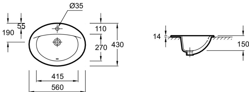
: Встраиваемая раковина 56 х 43 см. E4155. Коллекция: ПАТЮ. РАЗМЕРЫ (СМ): 56 х 43 см. ВЕС: 7.8 кг. МАТЕРИАЛ: Керамика. УСТАНОВКА: Накладные. РАЗМЕТКА СВЕРЛЕНИЯ ОТВЕРСТИЯ ДЛЯ СМЕСИТЕЛЯ: С 1 отверстием для смесителя, два размечено. ОТВЕРСТИЯ ДЛЯ СВЕРЛЕНИЯ: С 1 отверстием для смесителя. ОТВЕРСТИЕ ПЕРЕЛИВА: С отверстием перелива.
